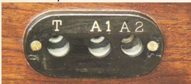
Particolare della presa antenna terra.
