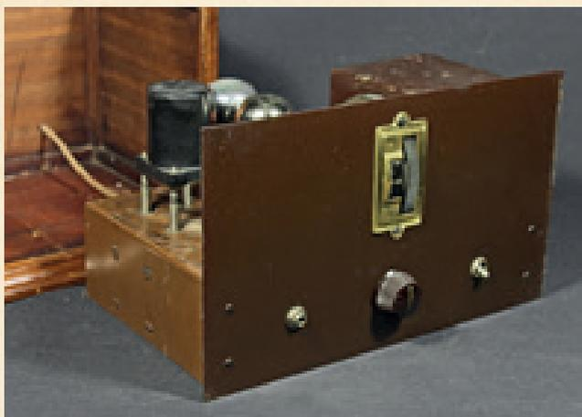
questo per meglio abbinare l'apparecchio all'arredo della casa in cui doveva essere installato. Sul pannello frontale la manopola graduata centrale a scorrimento e lettura verticale, arricchita da una mascherina d'ottone, comanda il condensatore variabile, in basso a sinistra una presa jack consente di usufruire dell'amplificazione a
