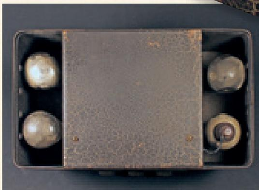
Vista da sopra del mobile; nonostante la rimozione del coperchio superiore l'apparecchio rimane completamente schermato.
