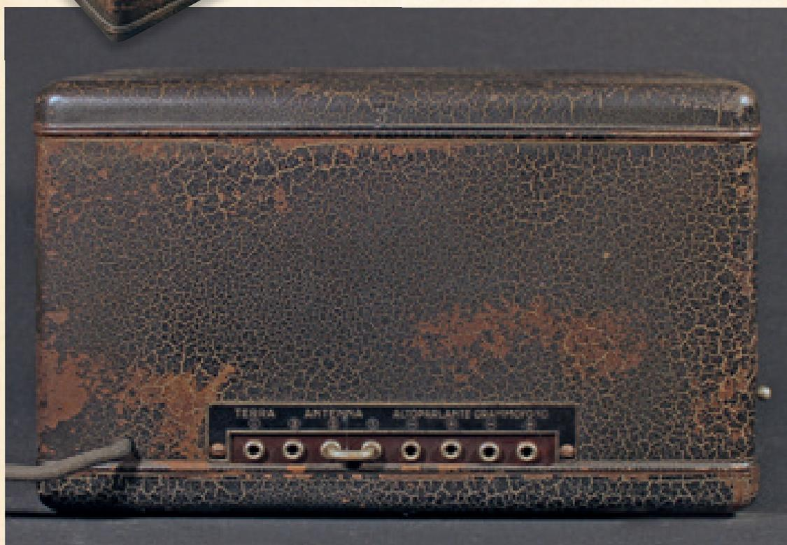
Vista posteriore; si possono vedere le varie prese di terra, di antenna, per l'altoparlante e addirittura per il grammofono.
