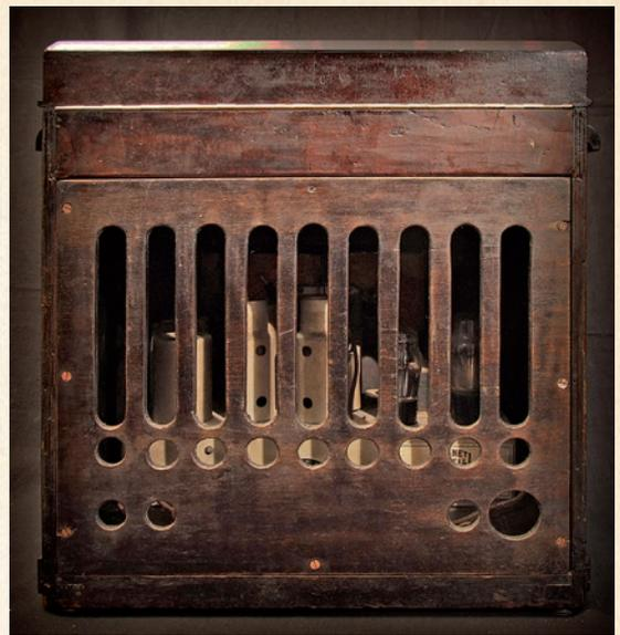
*è bene quindi smontare il telaio posteriore e togliere tutti i tamponi di cartone ondulato. Poi vanno tolte le quattro viti a galletto, che si allentano dal di sotto del mobile, e le due assicelle in legno, in modo che lo chassis molleggi sui cuscinetti di gomma».*
