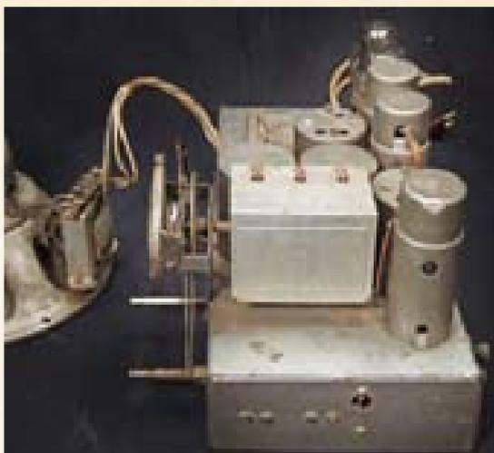
Al centro, a sinistra: il perno che agisce sul cambiogamma; a destra: la lampadina che illumina la scala di sintonia.
