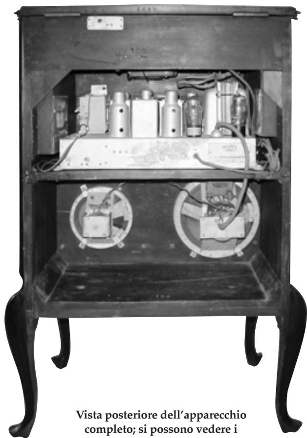
Vista posteriore dell'apparecchio completo; si possono vedere i due altoparlanti elettrodinamici in parallelo: uno per i toni bassi e l'altro per gli acuti.
