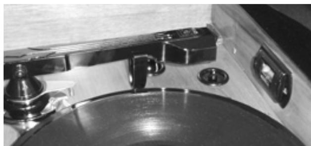
Particolare del vano fonografico; a destra si nota la lampadina che si accende automaticamente aprendo il coperchio illuminando così il vano.
